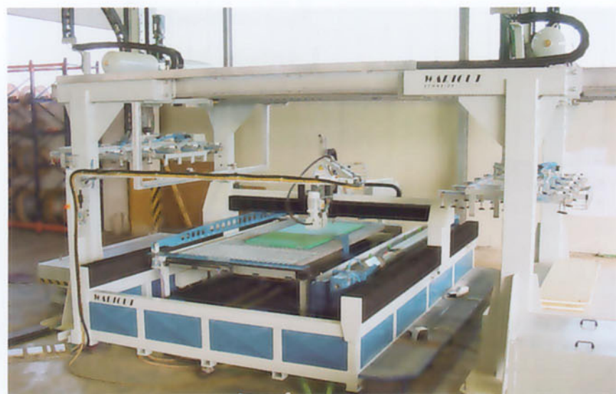
Wasserstrahlbearbeitungszentrum mit Ladeportal zum automatischen Bearbeiten von Brandschutztüren
