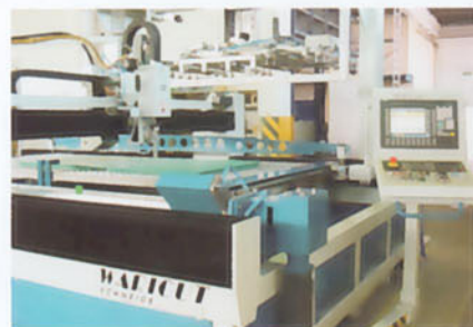
Beladen und Entladen werden mit Kombigreifer und Scherenhubtisch ausgeführt.
