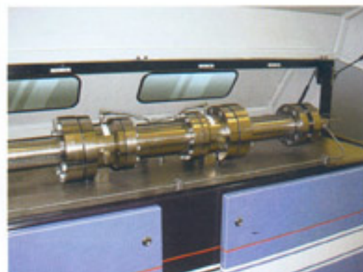
Alternativ kann das 2-stufige 6 kbar Pumpensystem auch aus HD-Übersetzern der Baureihe „BASIC“ aufgebaut werden.
