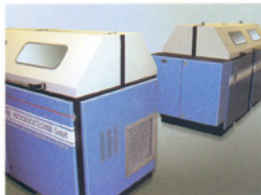
6 kbar Pumpensystem in einem Job Shop
