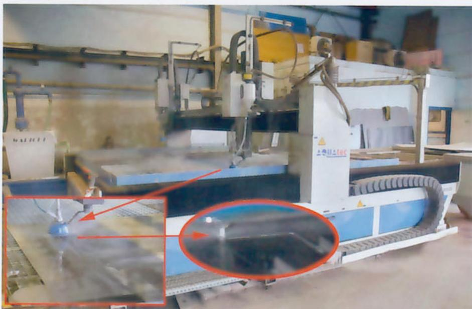
Bei der Doppelkopf-Anlage des Typs Waricut schneidet sich der haarfeine, mit Abrasivkörnern versetzte Wasserstrahl mit 4000 bar durch das Material
