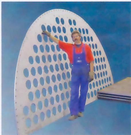
**Bei diesem großformatigen Bodenblech für einen Schlauchfilter kam es besonders auf hohe Maßgenauigkeit beim Einbringen der Bohrungen an (Bilder: Autor)**
