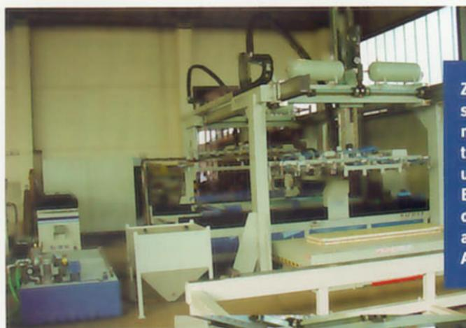
Zum Bearbeitungssystem gehören neben der Bearbeitungsmaschine und dem Be- und Entladeportal auch das Hochdruckaggregat und die Abrasiventsorgung
