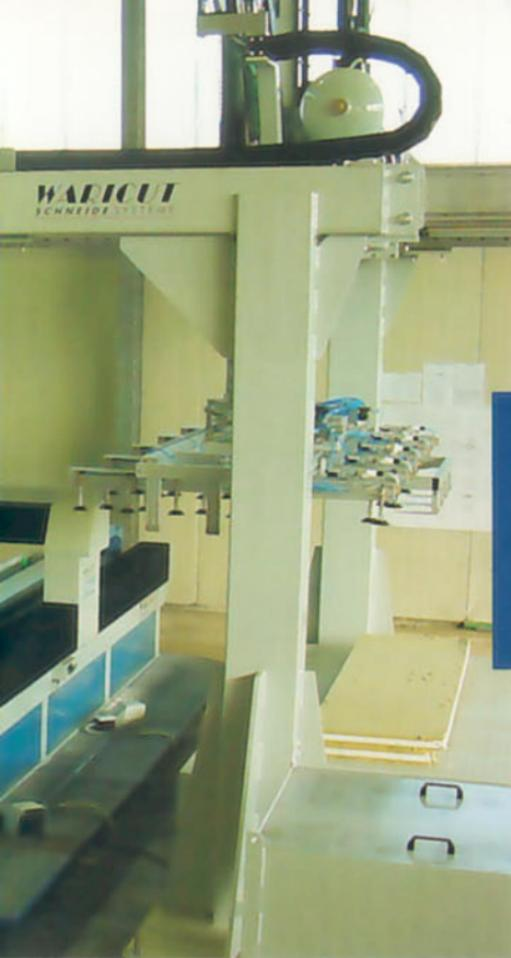
**Auf einem flexiblen Wasserstrahlbearbeitungszentrum werden Brandschutztüren und die zugehörigen Dämmstoffplatten automatisch produziert**
